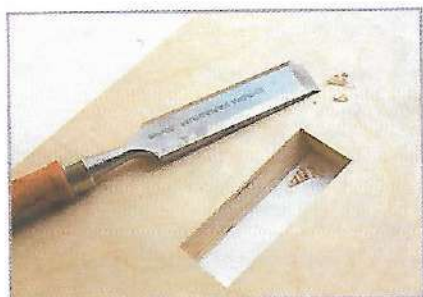
Рис. 5.11. Выполнение отверстия долотом
