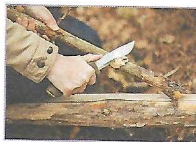
Рис. 5.2. Виды резания древесины вручную: а — раскалывание; б — строгание ножом; в — строгание рубанком; г — долбление долотом
