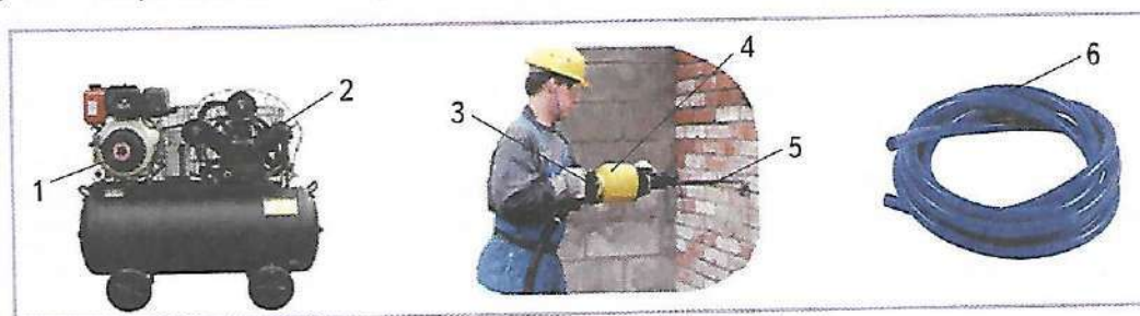
Рис. 4.16. Пневматический привод: 1 — первичный двигатель; 2 — компрессор; 3 — блок управления; 4 — вторичный двигатель; 5 — исполнительный орган (инструмент); 6 — шланг
