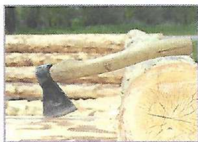
Рис. 5.7. Механические инструменты для ручной обработки древесины: а — топор; б — тесло; в — стамеска
