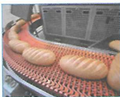
Рис. 2.24. Производственная линия для выпуска хлеба
