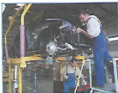
Рис. 2.25. Полуавтоматизированная производственная линия по изготовлению ходового узла автомобиля
