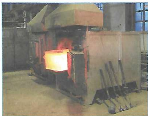
Рис. 5.2. Индукционная тигельная печь (а); муфельная печь (б)
