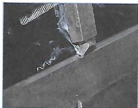
Рис. 5.12. Строгание (а) и долбление (б) металла
