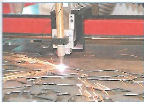
Рис. 3.2. Резание: а — лазером; б — механическими инструментами
