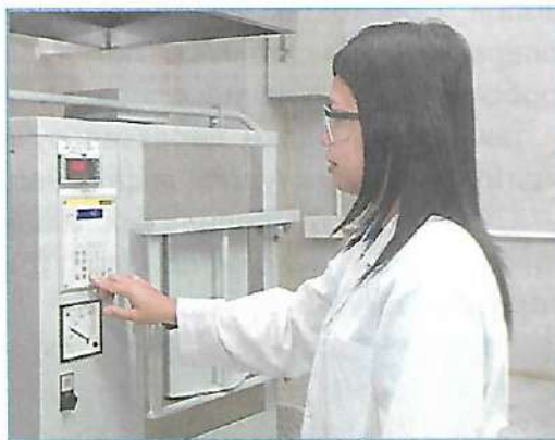
Рис. 5.2. Индукционная тигельная печь (а); муфельная печь (б)
