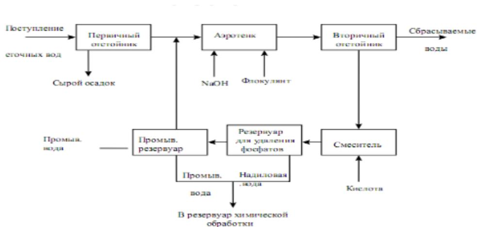
Рис.2.4. Технологическая схема опытного блока очистки сточных вод с использованием в качестве реагентов NaOH, кислоты и флокулянтов.
